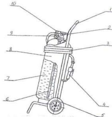
Після введення важеля ЗПП вогнегасний порошок під дією газу – витискувача по сифонній трубці через запірно – пусковий пристрій витискується у шланг. Перекривний ствол наводиться на вогонь і відкривається для проведення гасіння. При необхідності ствол закривається і вогнегасник переміщується в іншу точку, після чого ствол відкривається і гасіння продовжується.
